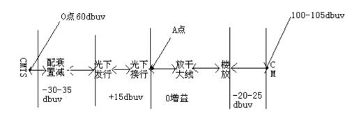
如果光链电路调试正确,衰减配值合理,图中 A 点到 CMTS 入口处 O 点之间设备完好,那么链路中 A 点的电平将始终被 CMTS-AGC 钳位在调试时的固定值上。根据 HFC 网络的设计特点,电缆网络的总增益是按零 db 设计,上行放大器的作用主要是用来补偿分支分配器和电缆的插入损耗,如果补偿过大或插入衰减不够,其结果是,假设大于 15dbuv,此时 A 点电平升高 CMTS 接收电平升高-通过 AGC 下行指令,CM 工作电平下降-A 点电平下降,重新进入锁定状态。整个链路中发生变化最大的是 CM 工作电平下降 15dbuv.前面说过如果用户室内噪声电平为一固定值,那么室内输出的有效载波电平和噪声电平的比值下降,导致 CMTS 接收端口的 C/N 值下降,严重时白天下降 3-5 个 db 以上,晚上就有可能在 5-10 个db 以上,使上行信道被噪声覆盖,从而造成大面积掉线。因此日常维护中,更换放大器后的调整必须规范从事。
