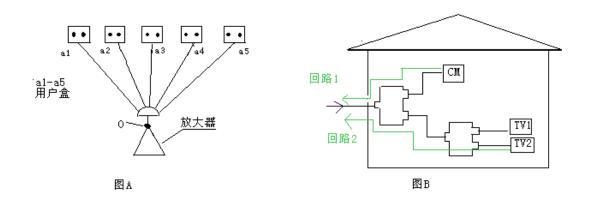
从图中可以看出分配网中,在 AGC 余量一定的前提下,电平差越大,CM 工作电平越低,因而从室内引入的噪声功率越大,网络的 C/N 值越差。电平差越小从室内引入的噪声功率越小,信道的 C/N 值越高。
